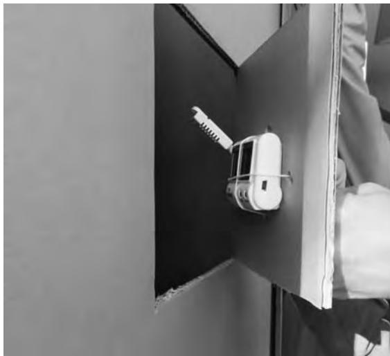
図10：江口週《ふたたび翔べるか一柱上の鳥》に設置した温湿度記録計
